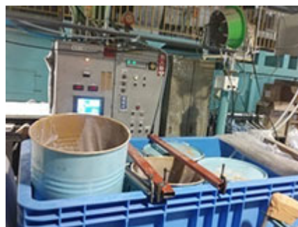
外壁パネル塗料冷却による塗料歩留りを向上
