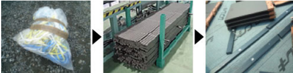
廃梱包材（ポリプロピレン）を瓦棧の原料として使用
