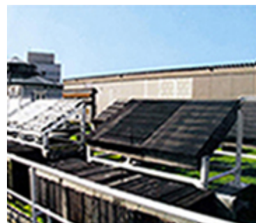
屋上で実施中の曝露試験
