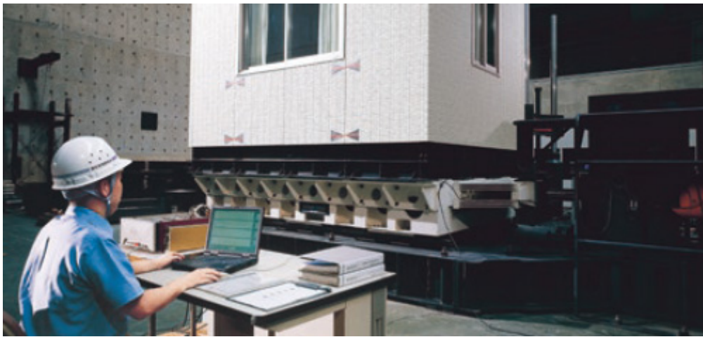
構造実験場での耐震性を検証する実大振動台実験
