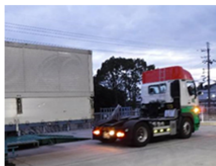
20tトレーラーによるスイッチ輸送
