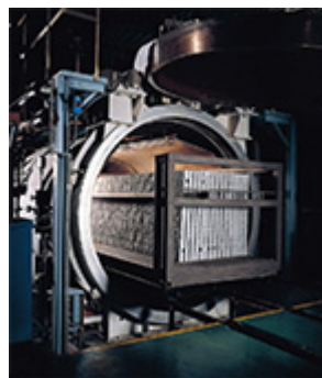
完全密封のタンクの中で高温・高圧で約20時間養生（二次養生＝オートクレープ養生）
