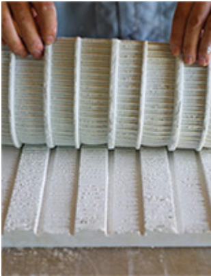
ダインコンクリートの原型型枠製作工程
