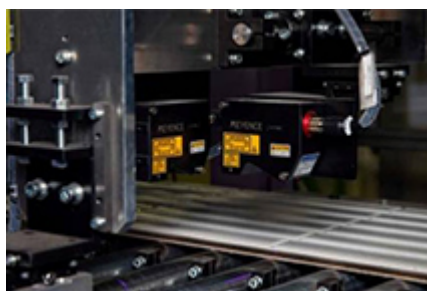
④【品質検査】 形状、色調検査システムで徹底的にチェック
