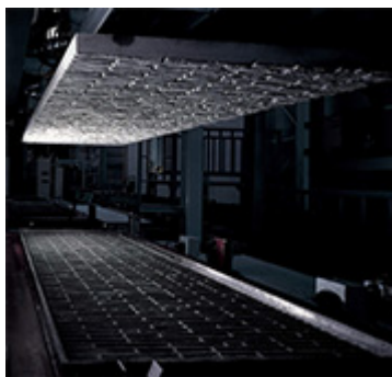
型枠に打ち込んだコンクリートを一定時間スチーム養生（一次養生）した後、脱型
