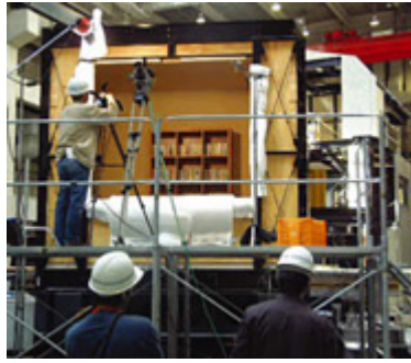
実大加振装置による家具転倒防止性能の実験
