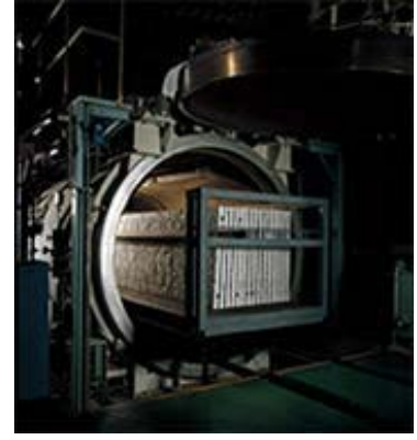
完全密封のタンクの中で高温・高圧で約20時間養生(2次養生=オートクレーブ養生)します
