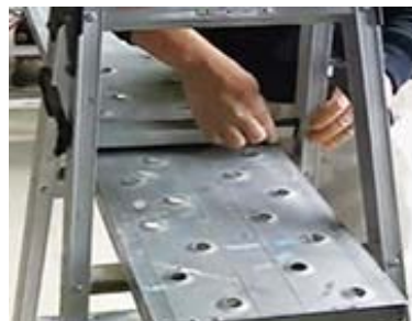
ワンタッチで簡単・確実に、脚立に足場板を固定
