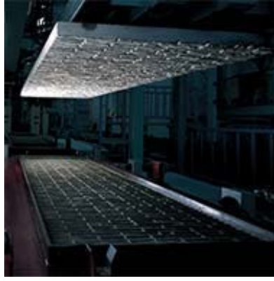
型枠に打ち込んだコンクリートを一定時間スチーム養生(1次養生)した後、型枠から外します
