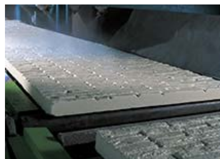
「ダイコンクリート」の塗装ライン。 耐久・耐候性を高める4重の塗装処理を実施
