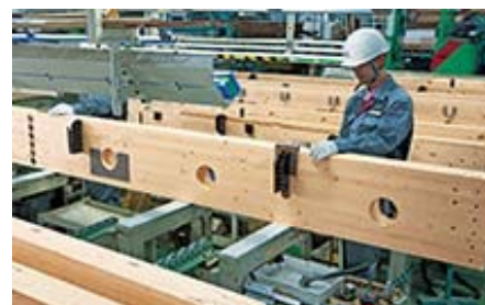
コンピューター制御で精巧にプレカットした部材に、構造用金物を正確にプレセットして出荷することで、施工現場での作業を省力化
