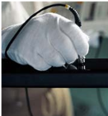
鉄骨の防錆塗装厚検査。 厳密に精度を確認します
