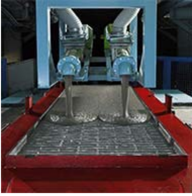
デザイン・形状共に豊富な外壁パネルは1枚ずつ型枠で成型し、製造しています
