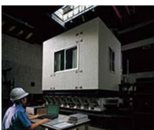
外壁実大振動実験で耐震性能を検証
