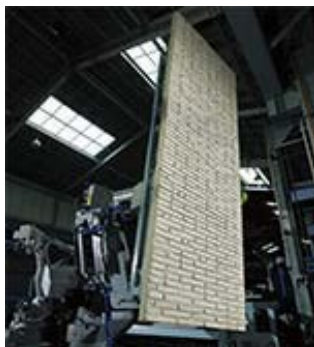
完成した外壁材の製品検査を実施
