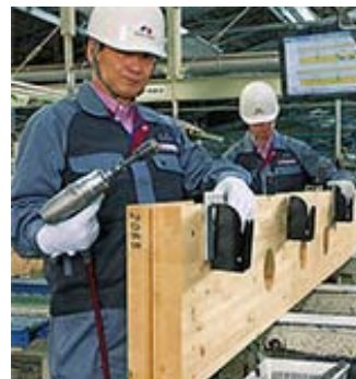
構造用金物は手作業で丁寧にプレセット
