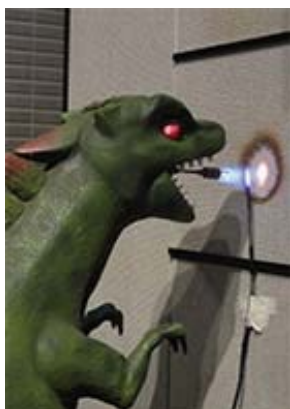
耐火実験で外壁の性能を検証
