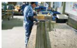
サッシ枠の分解(金属とガラスを分別)
