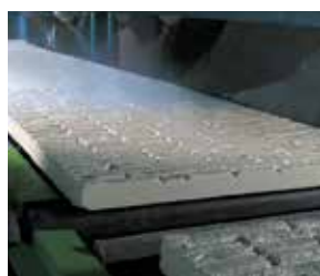
「ダインコンクリート」の塗装ライン。耐久・耐候性を高める4重の塗装処理を実施
