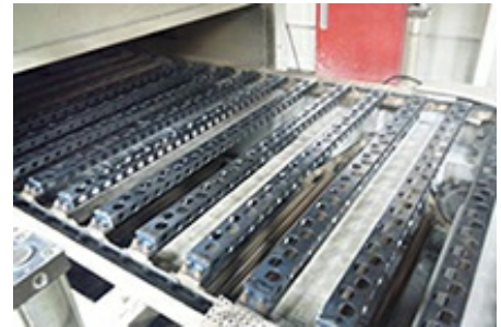
コンベアバー軽量化による乾燥炉省エネ
