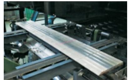
センサーカメラで一邸ごとの寸法や色調・光沢をチェックし、精度を確認
