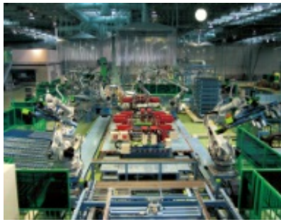
多品種の軸組を「完全邸別生産」できる 自動化ラインは住宅業界初
