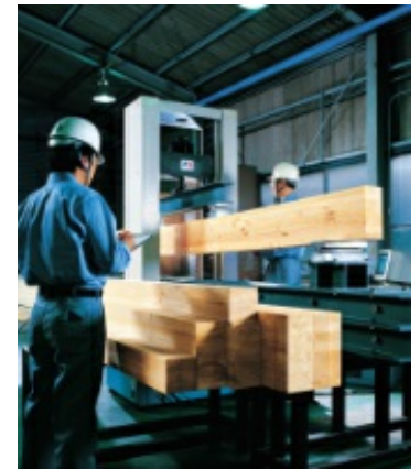
シャーウッド構造材の梁の曲げ強度試験。徹底した生產品質管理を実施
