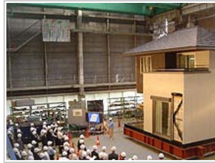
「シーカス」 実大振動台実験
