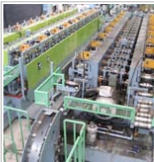
①形鋼成形工程 原材料となるC形鋼も鋼板の coils 材から自社工場成形
