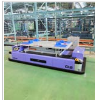
②自動搬送台車による搬送 仕掛かり部材は自動搬送台車（AGV）によって立体ラックまで自動で運ばれます
