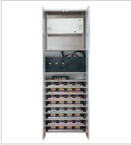
グリーンファーストハイブリッドの蓄電池システム (下部が蓄電池・高耐久鉛タイプ/容量8.96kWh・上部は太陽光発電併用パワコン+制御系機器)
