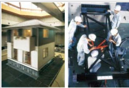
1979年に住宅業界初の実大振動実験を実施。その後も実験・検証を重ね、「免震」や「制震」などの技術を生み出してきました。
