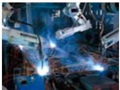
ロボット溶接で安定した品質を確保
