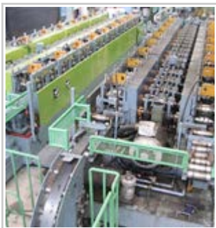
①形鋼成形工程 原材料となるC形鋼も鋼板の コイル材から自社工場で成形
