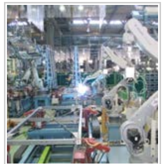
④軸組溶接工程 レーザーセンサーで形状を把 握、位置補正を加え、溶接口 ロボットで正確に溶接
