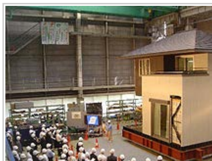
「シーカス」実大振動台実験
