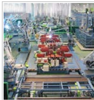
③軸組組み込み工程 1品ごとのCADデータと連動 して可動する組み込み治具で 位置決めを行い、部品を組み 込みます
