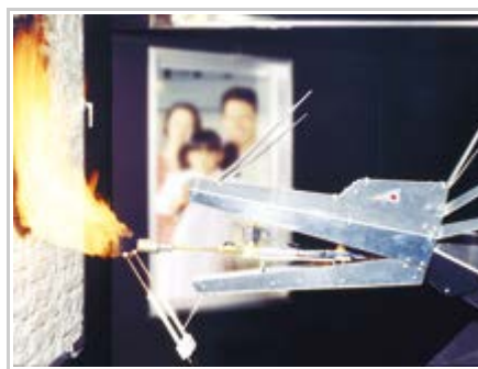
外壁の耐火実験で性能をチェック
