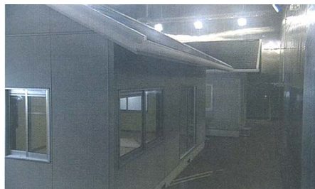
人工気象室における25年前の 住宅を使った断熱リフォーム 検証実験
